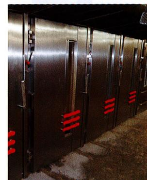
In den Thermoölofen der Heuft GmbH wird gebacken. Die Abwärme wird gezielt abgeführt und in Pufferspeichern bereitgestellt.
