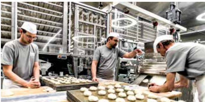
Neben Kaisersemmeln, die auf der KKM gestanzt werden, werden täglich zusätzlich 4.000 Stück Handkaisersemmeln, ausgewogen mit der König Kopfmaschine der Anlage, hergestellt.
